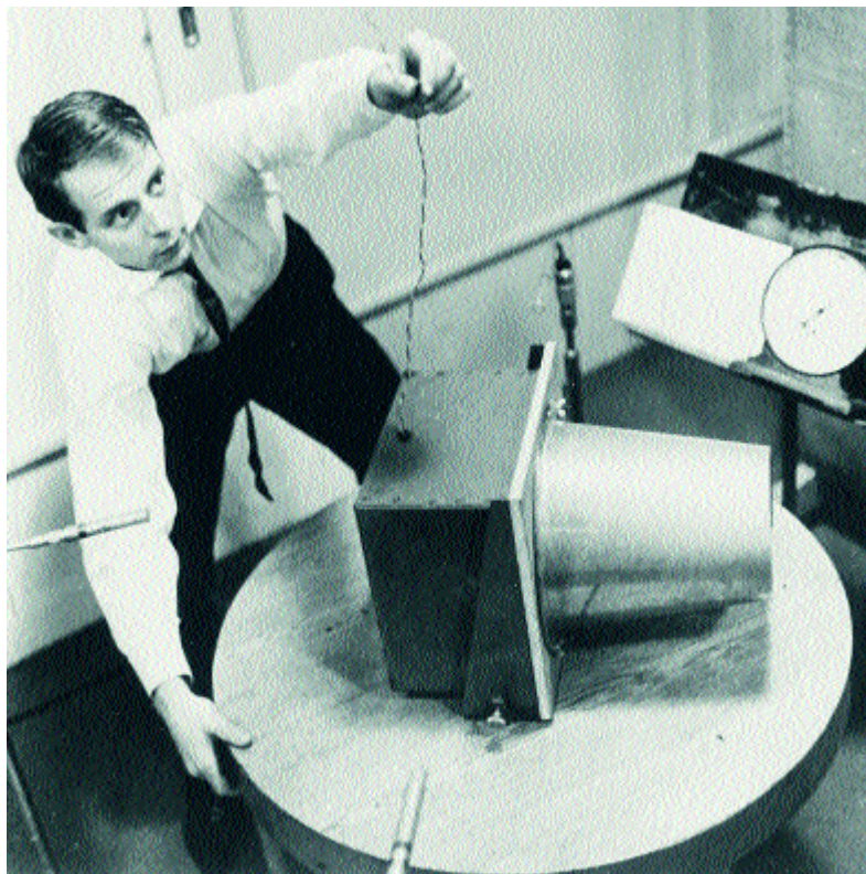
Rotationshögtalare som Stockhausen utvecklade under arbetet med Kontakte 1959.
